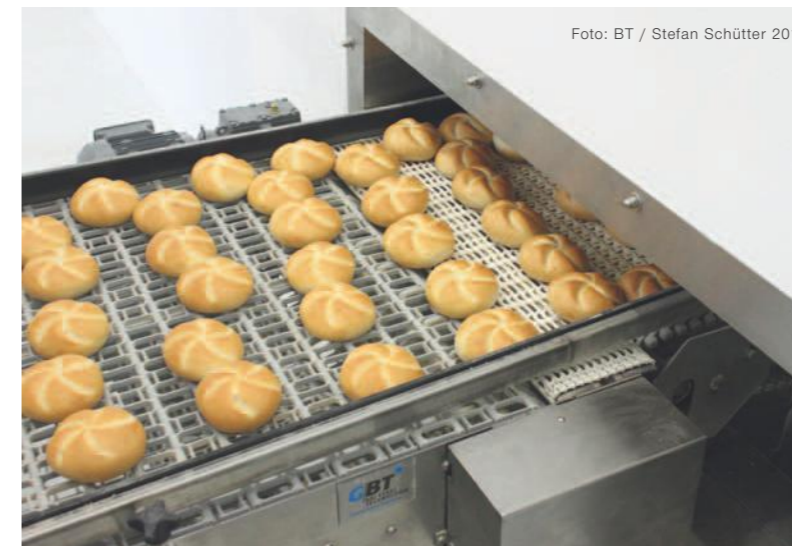
Die Ausgangs-Schnittstelle des ausgetauschten Bereichs der Linie 2 befindet sich hinter dem Ofen am Einlauf zur Kühlschnecke.
