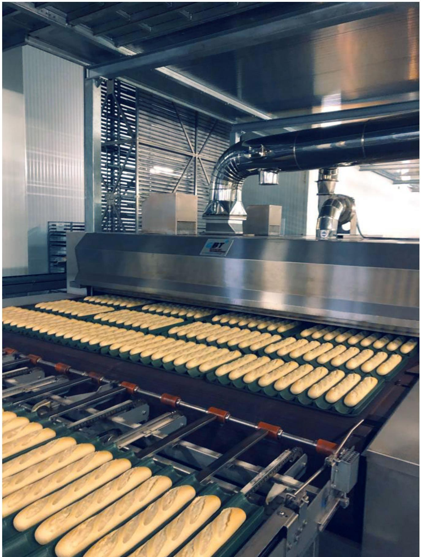
Esa instalación industrial de pan cerca de Barcelona tiene una capacidad de hasta 5.000 baguettes medias horneadas gracias al horno Mistral de GBT. Más que eso: con un consumo óptimo de energía ese horno túnel de sistema modular alcanza hasta un 30 % de ahorro de energía en comparación con hornos ciclotérmicos convencionales, gracias a la utilización óptima de los humos de combustión. Típico GBT: mejorar el rendimiento, reducir el consumo de energía.
