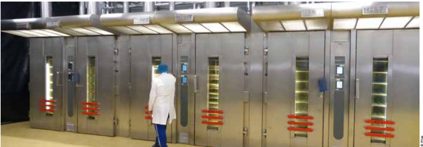
++ Neben Stikkenöfen gibt es einen Etagen-Durchlaufofen mit Thermoöl und Steinplatten von Heuft
