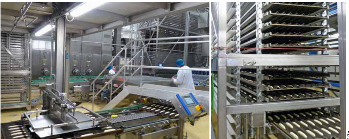
++ Das Ablegen der Teiglinge erfolgt auf beschichtete Bleche von Diane. Anschließend folgt der Gärprozess unter anderem in einem Paternoster-Schrank von GBT
