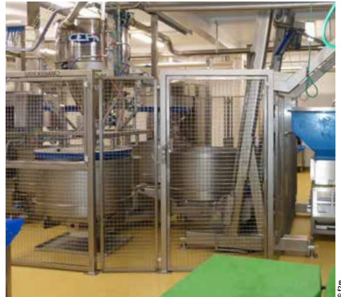
++ Ein Kneuter-Karussell von Sancassiano versorgt die Anlagen automatisch mit Weizenteigen. Zudem gibt es einzelne Kneuter für kleine Teig-Chargen
